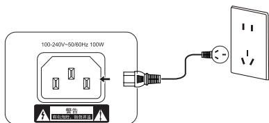
注意：请勿将本机与由变频器控制电力、或含有马达的设备(例如电冰箱、洗衣机、微波炉、或是冷气机)等装置在相同电路中使用。否则本机可能会产生杂音。如无法使用独立的电源插座，请在本机与电源插座之间使用电源杂音过滤器。
